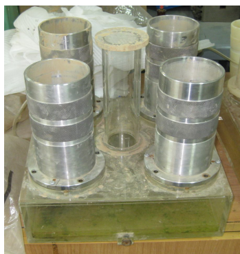
图6 正常固结土制备器
